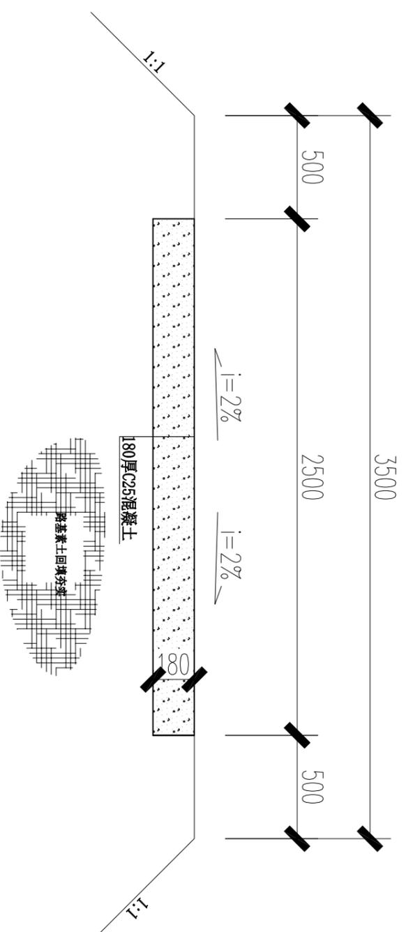
混凝土路面标准横断面
